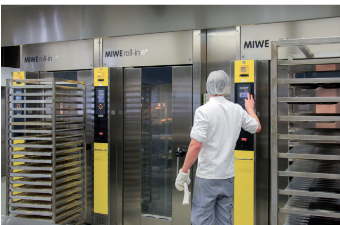
Speziell für die Confiserie Sprüngli wurde das Ofenmaß auf die Wagen- und Blechgröße angepasst.
