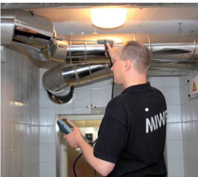
MIWE Mitarbeiter bei der Durchführung der Abgasmessung und DIN 8766.
