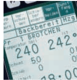
Moderne Elektronik macht Automatisierung erst möglich – sei es die jüngste Version der seit Jahrzehnten bewährten Steuerung MIWE DS (links im Text), die aussagekräftige Textanzeige der MWE CS (oben) oder die über eingesteckte Backsymbole kinderleicht zu bedienende MIWE FP 12 (unten)
