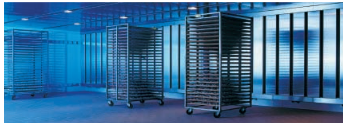
Innenraum einer TLK-Anlage mit patentiertem Luftführungssystem
